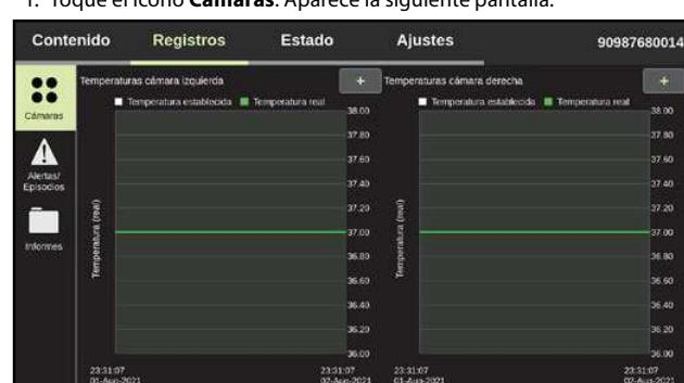
2. Toque el icono más (+) en la parte superior derecha de cada gráfico de la cámara de incubación para mostrar solo la cámara seleccionada. Si toca la lupa +/-, se ampliará/expandirá la escala de tiempo.
