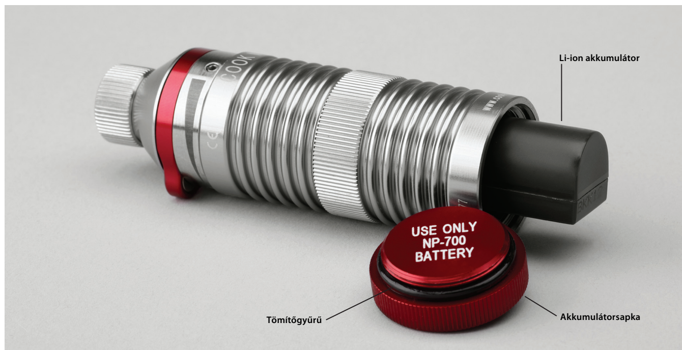
4. ábra. Az akkumulátorsapka levétele és a Li-ion akkumulátor betevése és kivétele
