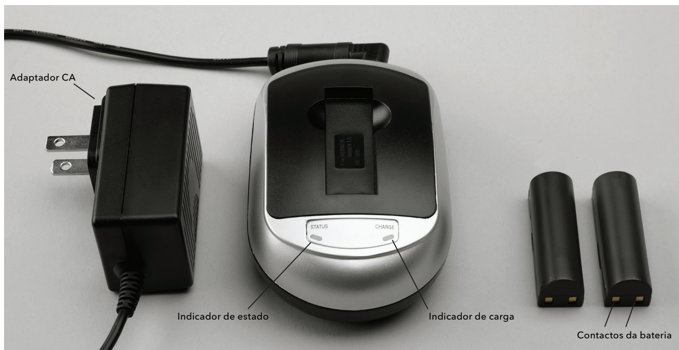
Fig. 5. Carregador de bateria e vista da extremidade da bateria
