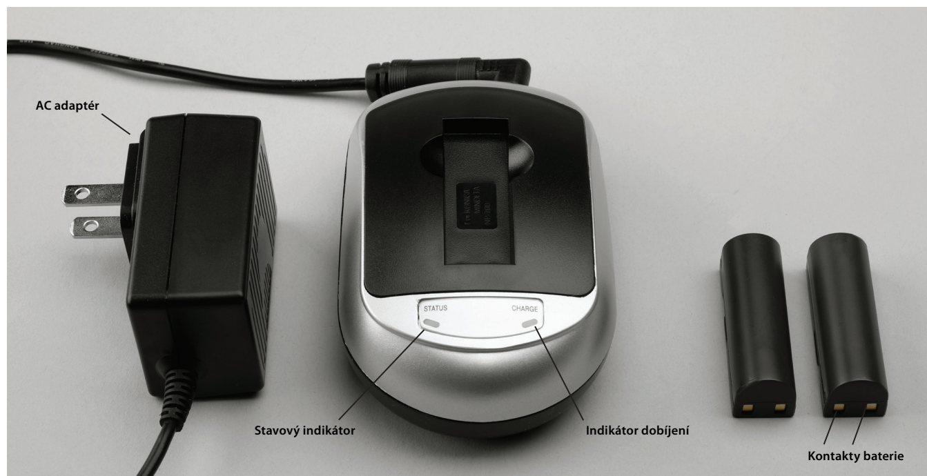
Obr. 5. Dobíječ baterie a pohledy na konce baterie
