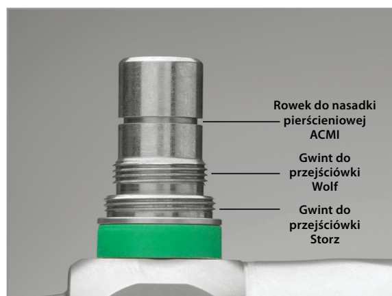
Rys. 6. Standardowe uniwersalne złącze światłowodu
