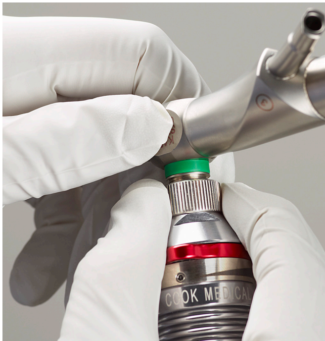
Fig. 2. Fixar a VueLite a um endoscópio
