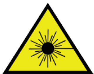
ADVERTÊNCIA–Radiação laser visível e invisível.
